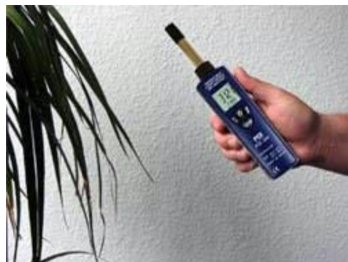
Das Thermo-Hygrometer im Innenbereich.
