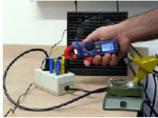
Das Ampere Messinstrument PCE-DC 1 beim überprüfen eines Verbrauchers
