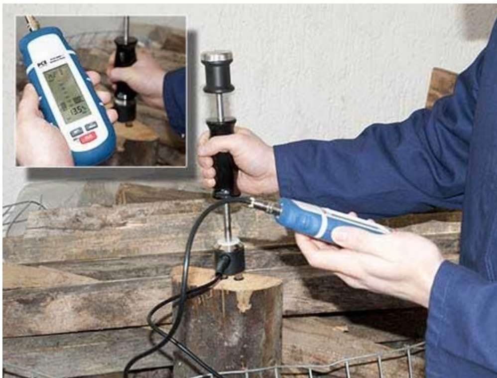
Hier misst der Universalfuchtemesser mit seiner externen Rammelektrode
