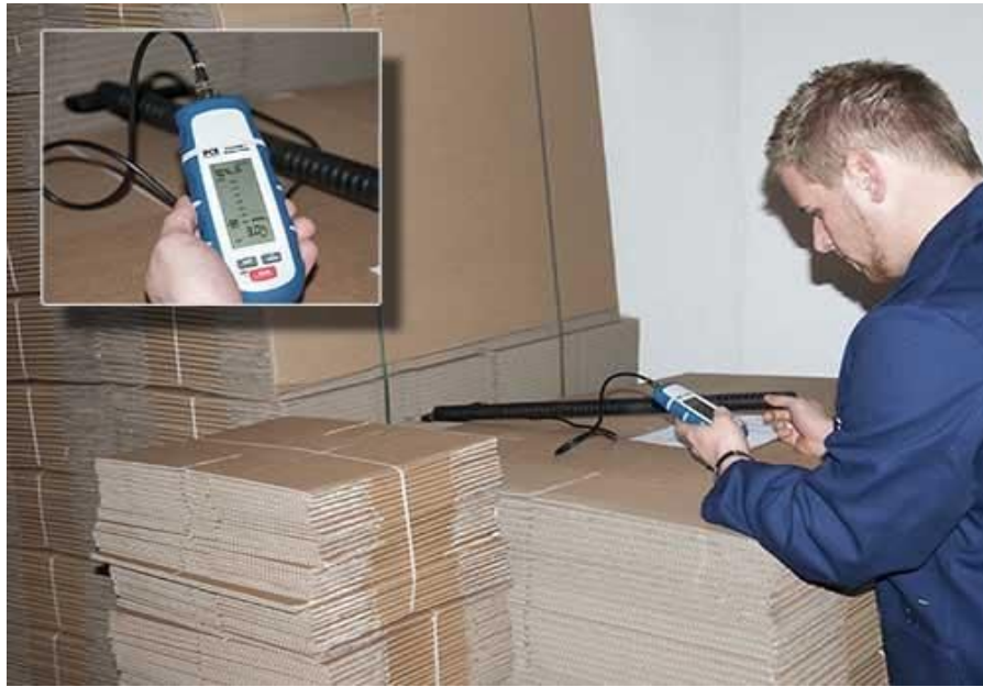
Der Techniker misst mit dem Universalfeuchtemesser im Wareneingang
