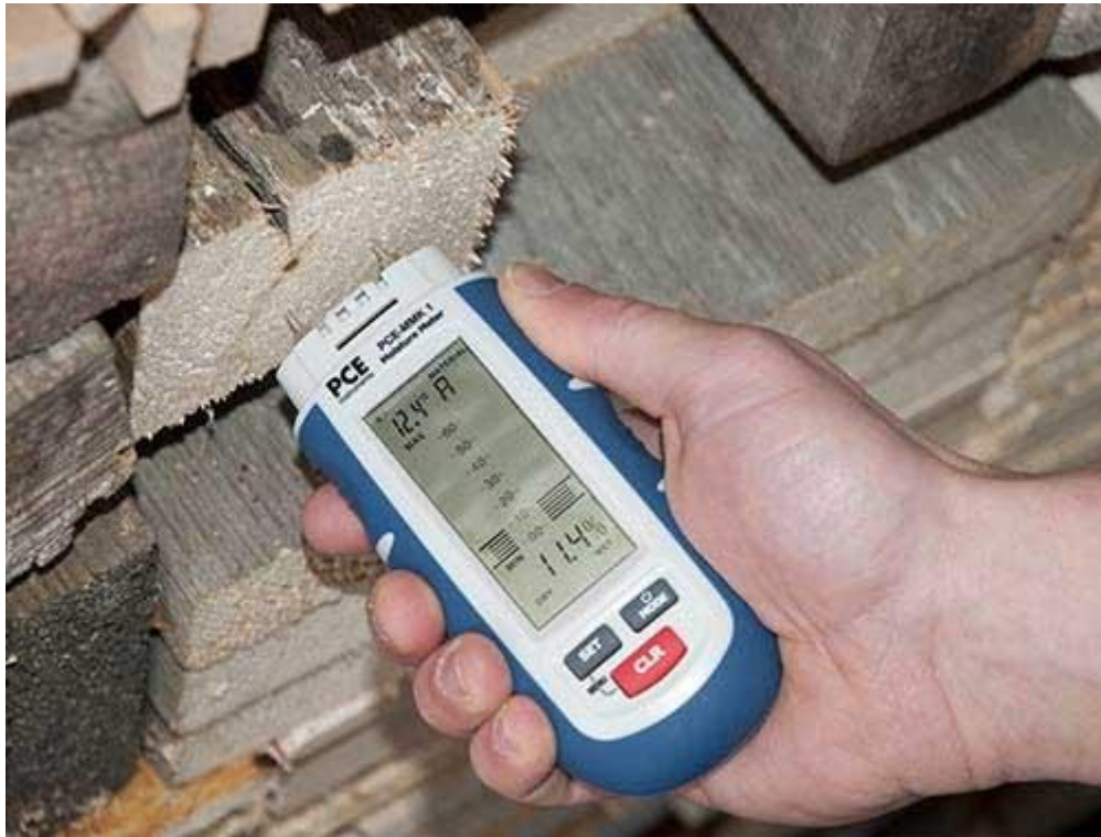
Hier sehen Sie den Universalfuchtemesser beim Messen mit den internen Messnadeln
