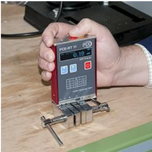
Das Rauheitsmessgerät bei einer Oberflächenprüfung an einer Klemmbanke.
