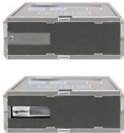
Hier sehen Sie die Tastspitze mit Schuttschieber vom Rauheitsmessgerät TMR120.
