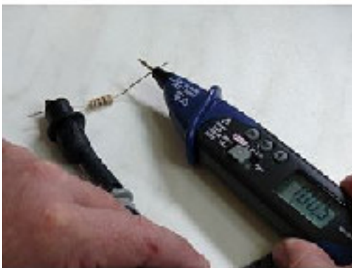
Hier sehen Sie das Stift-Multimeter PCE-PDM1 bei der Überprüfung eines Widerstandes.
